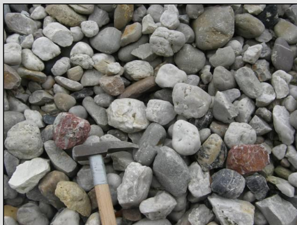
Horní Bříza (2009) Zaoblení valounů i materiál jsou velmi různorodé. Přebývá mléčný žilný křemen, tmavé lydity, křemenné pískovce a různé typy metamorfovaných hornin.
