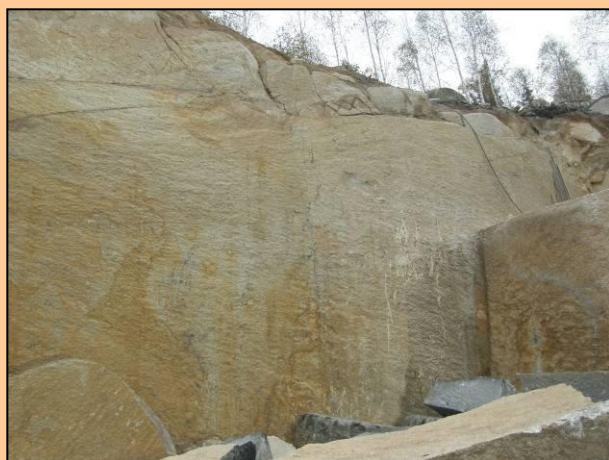
Tis u Blatna (2009) Odlučné plochy tiské žuly, pod povrchem postupně rozvětrávající v žulové eluvium a pevná zaoblená jádra
