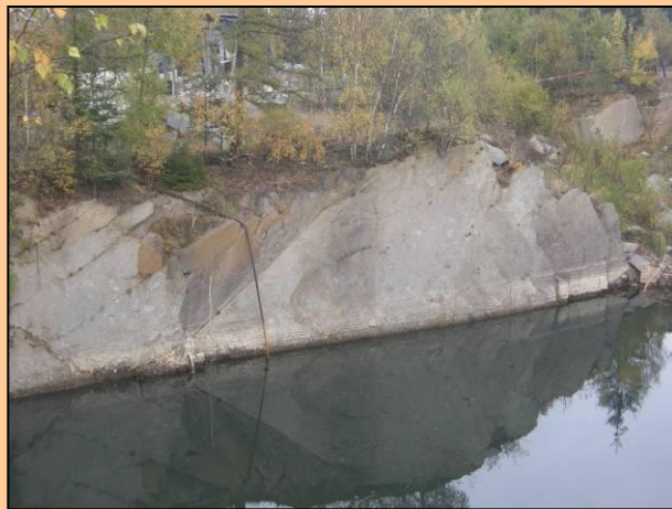
Tis u Blatna (2009) Vertikální puklina z patrnými šikmými puklinami a povlaky sloučenin železa a manganu
