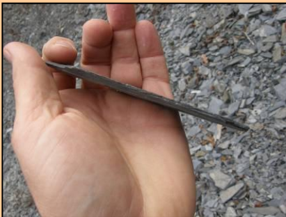
Rabštejn (2009) Fylity tvoří pevné tenké tabulky, které se daly dobře opracovávat na střešní krytinu. Podobně kvalitní materiál je znám až z Porýní nebo Jeseníků.
